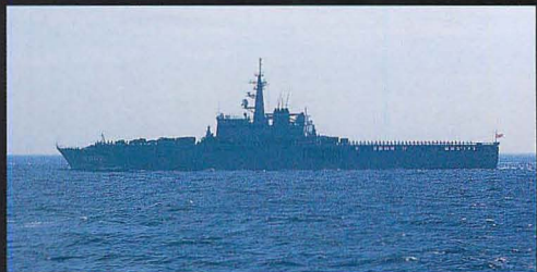
▲大型輸送艦「くにさき」。陸上自衛隊などの車両、人員の輸送支援などで使用されるほか、災害時には約1000人の被災者を収容し医療活動等の救難業務にもあたることができる。エアクッション型揚陸艇LCACを2隻搭載し、港湾設備等が被災しても物資の揚陸を可能としている。今回は、甲板上に陸上自衛隊の車両を搭載しているのが見られた。
