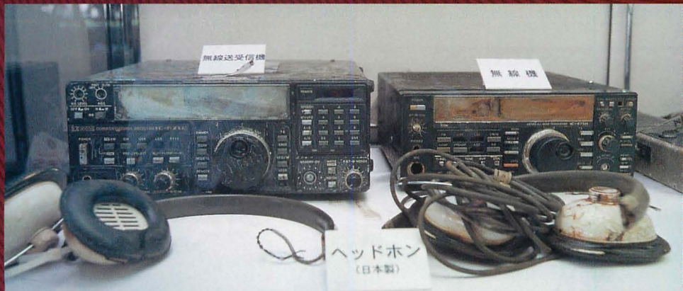
▲HF受信機「アイコム IC-R71E」と430MHz帯オールモードトランシーバー「アイコム IC-475H」。「IC-475H」は「IC-375D」の海外バージョンだ。「IC-R71E」では、乱数放送での「指令」を受信していたのだろうか？
