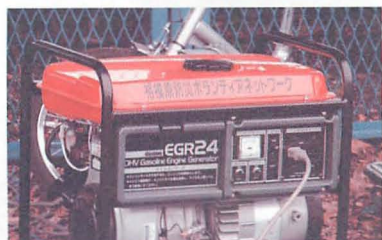
▲電気が来ない間、商用100ボルトの電気を供給する「発動発電機」がイザというときに活躍します。小さいものはお祭りの屋台で使っていることがあります。
