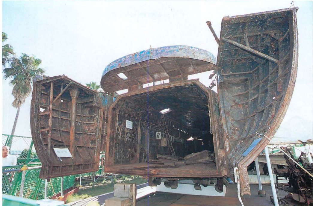
▲船尾には観音扉が設けられ、その中に「小型舟艇」が収納されていた。その下には、普通の漁船ではありえない、4基のスクリーンも見える。このスクリーンと強力なエンジンで、高速航行できたと推察される。
