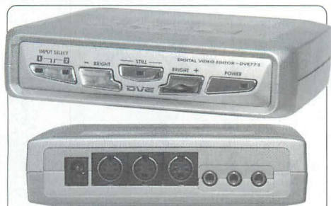
▲画像安定装置の1つ、プロスペックのDVE773。デジタルTBCを搭載した高画質設計が魅力。最新機種DVE774も登場している。
