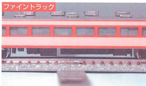
▲1mm厚の鉄板で段差を付けてみると…。重いモーター車が通った場合左の「ファイントラック」はしなりも弱くレールの段差も小さい。右の「ユニトラック」は独立した「ユニジョイナー」のため、一体感が乏しく、段差もしなりも大きい。床の段差がさらに大きくなると、差はもっと広がるだろう。
