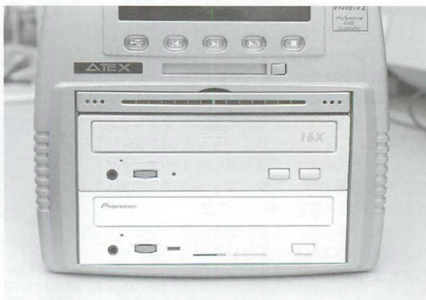
▲上が読み込み用のDVD-ROMドライブ、下が書き込み用の記録用DVDドライブ。写真の製品には、記録用ドライブにはパイオニアの4倍速対応DVD±R/RWのDVR-A06Jが使用されている。
