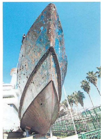
▲船首部は、高速航行に適したV字型をしている。船体のところどころに開いた穴は、巡視船の銃撃によるもの。高速航行のために、船体鉄板は薄く作られている。
