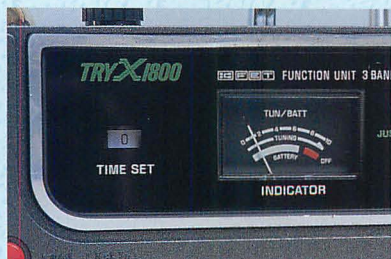
▲白を基調としたSメーターの印刷が映える。Sメーターの左脇にはタイマーの表示が見える。
