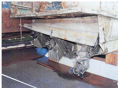
▲小型舟艇も“イカ釣り漁船”にはありえない、3基のスクリューが装備されていた。高速仕様を隠すために、スクリューを隠すためのカーテンも設置されている。
