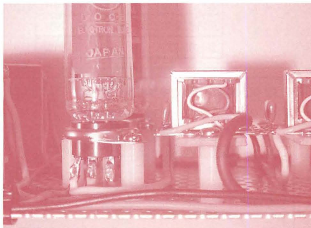
▲真空管とラグ端子をスペーサーでシャーシに取り付けたところですよ。
