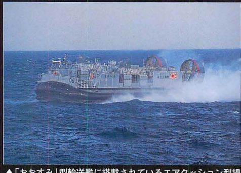
▲「おおすみ」型輸送艦に搭載されているエアクッション型揚陸艇LCAC (エルカック)。90式戦車1両を積載して航行できるほど積載能力が高い。
