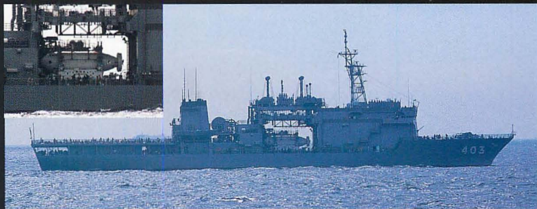
◀観閲部隊の中心となる観閲艦は護衛艦「しらね」。全長159m、基準排水量5200t、対潜ヘリ3基搭載のこの艦は「こんごう」型イージス艦を除けば海上自衛隊でも最大クラスの護衛艦だ。観艦式本番では小泉首相が乗艦し受閲艦艇部隊を観閲することになる。
