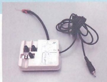
▲RCAプラグの根元が断線気味。古いプラグを切り取り、50円で購入したプラグに付け替えれば、復活だ。
