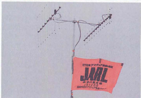
▲市役所勤務のアマチュア無線家が集まって、防災啓蒙のためのハムクラブを開局し、人命救助のための通信訓練などを行いました。2つ以上の周波数で運用し、通信を確保します。今回は訓練なので統制局のある方向に指向性アンテナを向けて設置しました。
