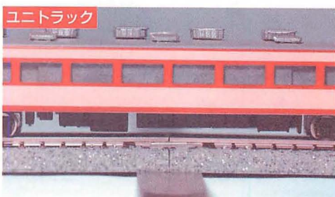
▲1mm厚の鉄板で段差を付けてみると…。重いモーター車が通った場合左の「ファイントラック」はしなりも弱くレールの段差も小さい。右の「ユニトラック」は独立した「ユニジョイナー」のため、一体感が乏しく、段差もしなりも大きい。床の段差がさらに大きくなると、差はもっと広がるだろう。
