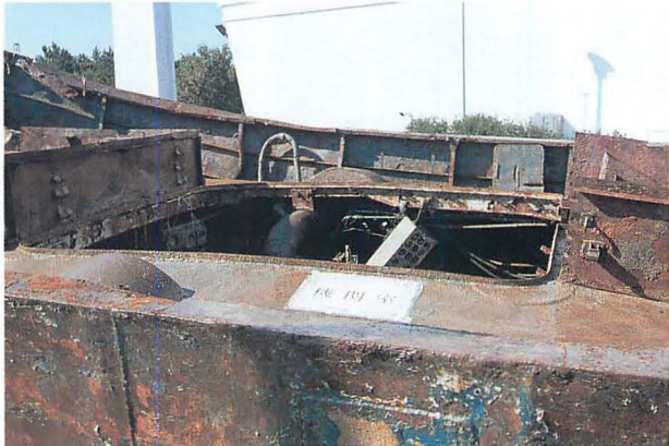
▲強力なエンジンが搭載されていた機関室跡。ここから船尾のスクリーンが、長いシャフトで結ばれているという。
