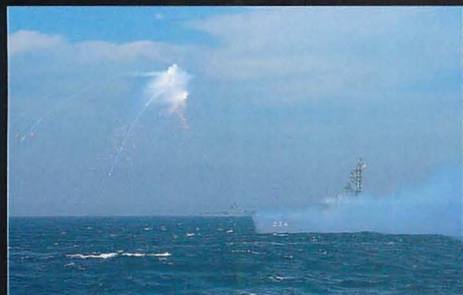
▲核兵器、生物兵器、化学兵器などの攻撃により汚染された船体を海水で洗浄する「甲板散水」を行いつつ、IRフレア（赤外線誘導ミサイルを回避する際に使用する）を発射する護衛艦「とね」。フレア発射後船体が煙幕で見えなくなった。見事なカムフラージュだ。
