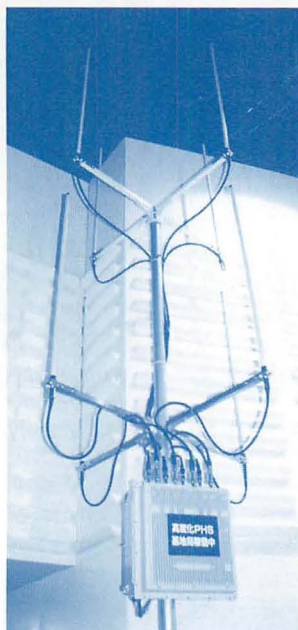
▲PHSコーナーの一角には、新型基地局に接続された2段型アンテナ（実稼動）が設置されていた。圧巻。
