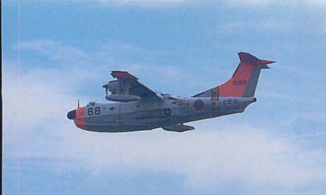
▲受閲航空部隊として飛来した救難飛行艇US1-A。この飛行艇は波高3mまでの海面で離着水が可能。また、航続距離も約1500kmと非常に長く、日本周辺の広範囲での救難活動に活躍している。現在現役で活動している飛行艇としては世界唯一と言っていい。
