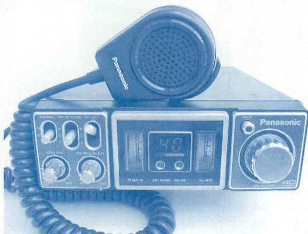
▲40ch AM 5W機の「RJ-3250」。チャンネル表示の両脇にあるメーターは、左は普通のSメーター、右は送信時には変調度表示メーター、受信時にはモニター音のVU計となる。
