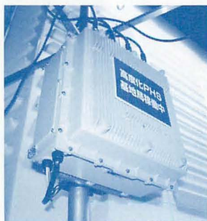
▲DDIポケット向けに開発・製造された新型基地局。8チャンネル対応。既存機種よりも本体の厚みは増したが、高性能コンパクトは相変わらずだ。
