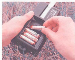
▲「CS100」は単3電池6本で電源を確保しています。
