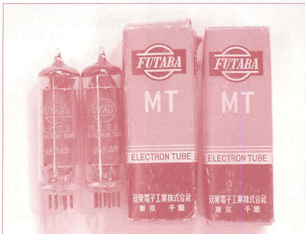
▲今回のアンプの試作に使用した双葉電子工業の真空管50C5。
