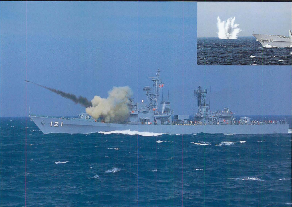
▲対潜ロケットランチャー、71式ボフォースロケットランチャーを発射する護衛艦「ゆうぐも」。発射の瞬間、文字通り耳を劈くような音と共に1500m先の海上に着弾、しばらく間を置いて海面に水柱が立った。
