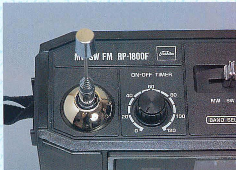
▲ロッドアンテナは天面左にある。ロッドアンテナの脇にあるツマミはタイマーセット用のもの。搭載されているのはON/OFF可能な120分タイマーだ。
