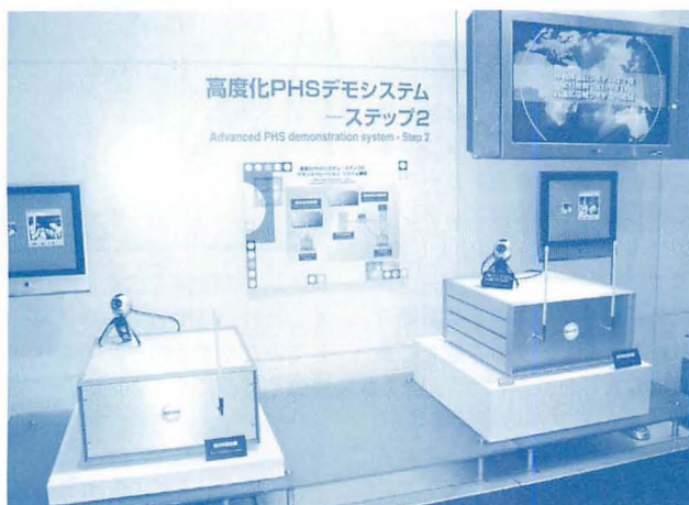
▲1Mbps伝送対応の、20mW基地局（右）と10mW端末（左）。実際に電波を飛ばしての実演ではなかったが、2～3年以内の実用化を目指しているようだ。
