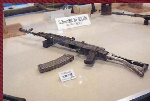
▲アサルトライフル「AKS-74」。5.45mm小口径高速弾を発射するAK系の新鋭小銃だ。旧ソ連がアフガニスタン侵襲で、特殊部隊に実戦投入したのが最初と言われる。マガジンがスチール製であることや、レシーバーに☆マークが打刻されている銃もあるところから、北朝鮮自国製と目されている。
