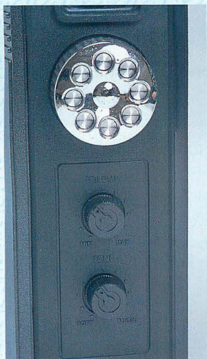
▲周波数ダイヤルは右側面に付いている。その下にあるのは音量、トーンツマミ。
