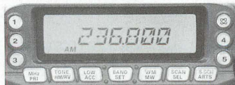
▲オートモードに設定すれば200~300MHz台の軍用エアバンド帯で自動的にAMモードに切り替わる。うれしい機能だ。
