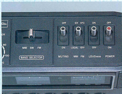
▲天面中央にはバンド切り替えスイッチ、右側には感度切り替え、ラウドネススイッチが配置される。
