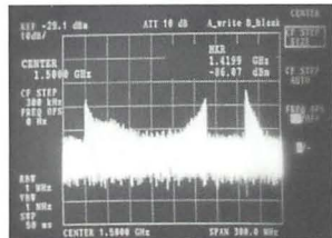
▲1.5GHz帯の波形。センターの落ち込みが少々気になる。
