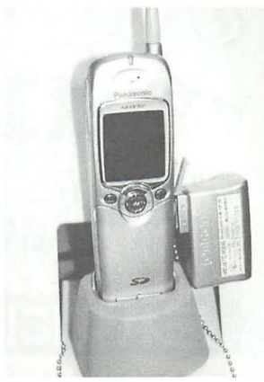
▲九州松下製feelH™端末KX-HF300に装着されたBluetoothアダプタ。データ通信関連機器はAirH™以外も品揃えが豊富だ。
