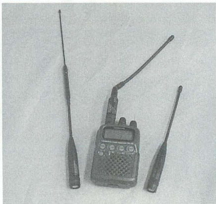
▲BNCコネクタなので、市販されている各種アンテナが使用可能。
