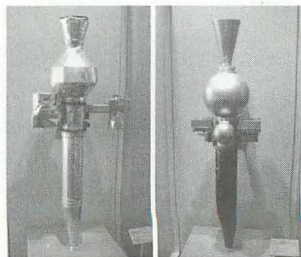
▲写真-8、9：月面に打ち込まれる観測機「ペネトレータ」のフライト用と試験モデル。
