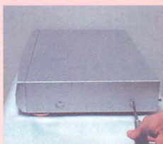
▲上カバーを外すには両サイドパネルのネジを4本、バックパネルの5本、合わせて9本を外すだけだ。
