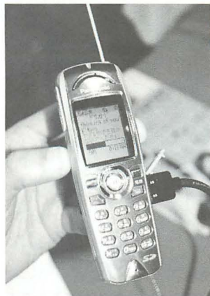
▲九州松下製の新型feelH™端末KX-HS110のデモ機も展示されていた。他機種よりも液晶が明るく見易くなっていた。SDカードにも対応している。
