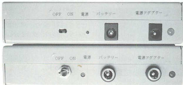
▲ケースそのものは同じだが、スイッチパネル部に少し変更が加わっている。上が新、下が旧バージョンで、スイッチ等の突起物が目立たなくなっている。
