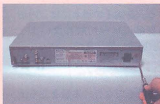
▲上カバーを外すには両サイドパネルのネジを4本、バックパネルの5本、合わせて9本を外すだけだ。
