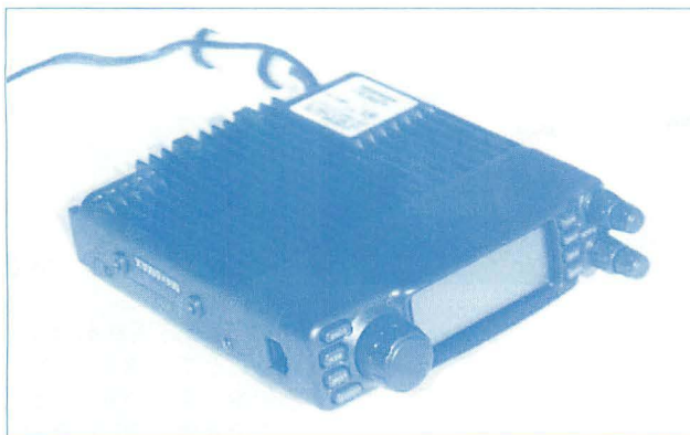
▲C7100の底部。放熱効果が高くなるように工夫してある。
