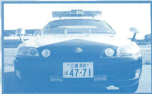
▲バンパー部の前面警光灯はトヨタ純正タイプ。赤色灯には探証用のストロボが装備されている。
