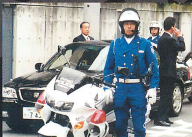
▲スピーカーと赤色灯が一体化した。また、方向指示器のライトもボディ部に埋めこまれている。
