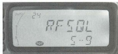
▲セットモード「24」はRFスケルチ機能。電波の強さが設定以上でないと音声が出られないようにする機能だ。
