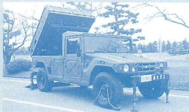
◀高機動車の荷台にランチャーが装備されている
