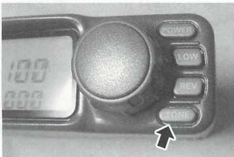
▲操作パネル右下の『TONE』キーを押すとトーンスケルチ、DCS機能を働かせることができる。
