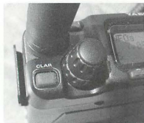
▲クラリファイアキーはアンテナ端子下にある。このキーを押すと受信周波数のみ変更できる。帯域の狭いSSBで交信するとき利用し、周波数のズレを補正する。
