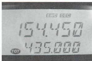
▲『TONE』キーを何度か押して『ENC/DEC』表示をさせるとトーンスケルチの動作となる。
