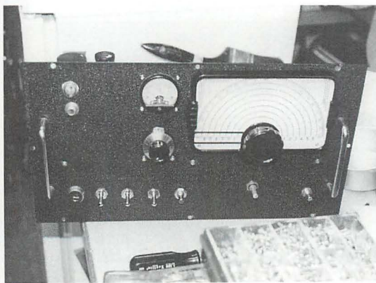
⑯書込式バーニアダイヤルとSメータを付けると何とかフロントパネルも様になって来ました。メータの下は、センターゼロ目盛のBFO用バーニア。
