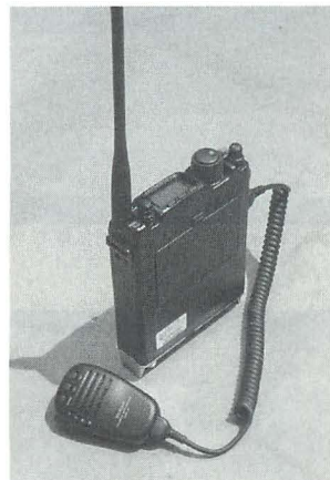
▲ FT-817はともするとV/UHF帯のポータブルと感じてしまうが、れっきとしたHF帯でもある。付属のホイップアンテナだけでなく、HF帯のアンテナを用意したいところだ。
