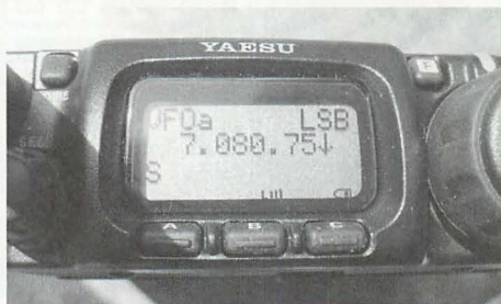
▲クラリファイア動作中にセレクトツマミを回すと受信周波数がアップダウンする。そのときディスプレイには「↑」「↓」が表示され、上下どちらの方向に周波数が変更されているか示してくれる。
