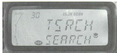
▲トーンスケルチ動作状態でセットモードに入り、「30 TSRCH」を選択するとトーン周波数サーチがスタンバイになる。『BAND』キーを押すとサーチが開始する。
