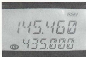
▲『TONE』キーを何度か押して『DCS』表示をさせるとDCSの動作となる。
