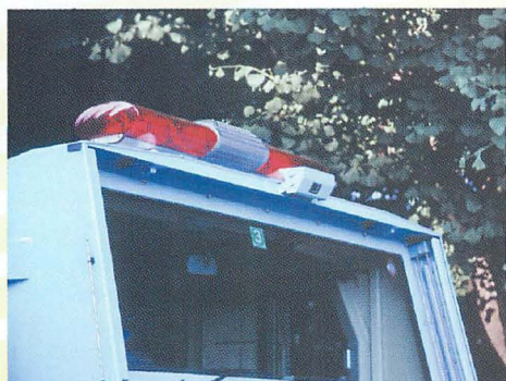
▲状況によってはフロントガラス部も防護板で防御する。上部には前方確認用のカメラがある。
