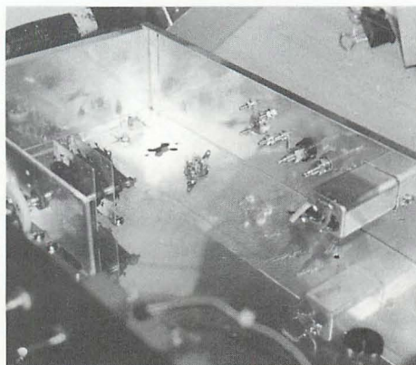
⑬シャーシー後部。右の四角い物は測定器から外したノイズフィルター。
