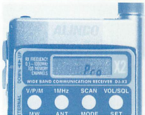
▲イーザーモード時のディスプレイにはEASY(上)と、エキスパートモード時にはPro(下)と表示される。
