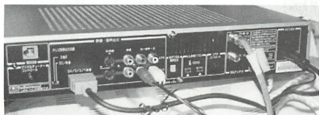
▲写真1: BSデジタルの受信チューナー端子への繋ぎはこれでOK。左からビデオ用D端子、赤白オーディオ端子、BS-IF接続、電源コード。
