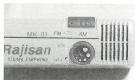
▲AMとFM、TVのコード切り替えスイッチ。下のダイヤルはボリュームつまみ。
