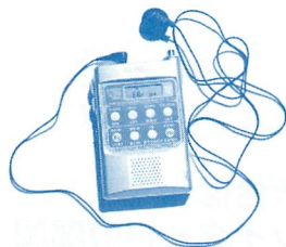
▲イヤホンアンテナを使用すれば隠密受信に最適。
