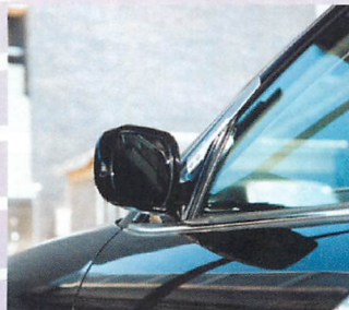
▲助手席ドアミラーにはナビミラー固定用の特製ステーが付けられている。
