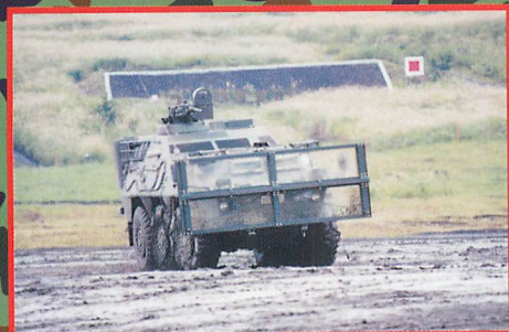
▲新装備の96式多目的誘導弾発射装置。光ファイバ赤外線誘導の最新式誘導弾。
