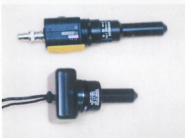
▲上が新型のCN-888H2に6.2ミリレンズを装着したもの。下は旧型のCN-888Hに4ミリレンズを装着したものです。
