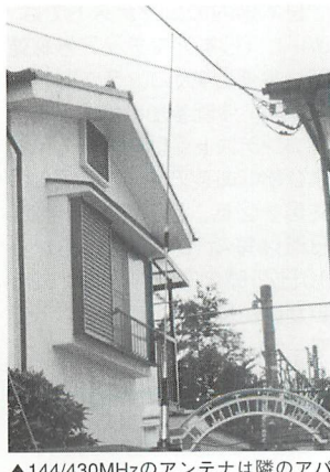
▲144/430MHzのアンテナは隣のアパートの掃除用具入れ倉庫にマグネット基盤を使って簡単に設置。
