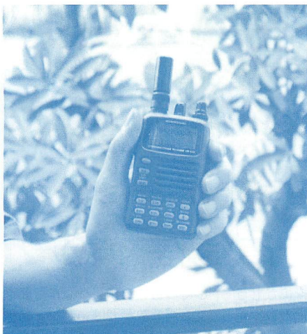
▲盗聴波を探すときは短いアンテナを付けて目立たなくしている。VR-500はこのアンテナでも電波をそこそこ拾ってくれる。
