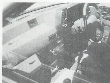
▲サイレンアンプは佐々木製のSAP-50Bを搭載。無線機格納ボックスはそのままであるが、無線機は外されている。
