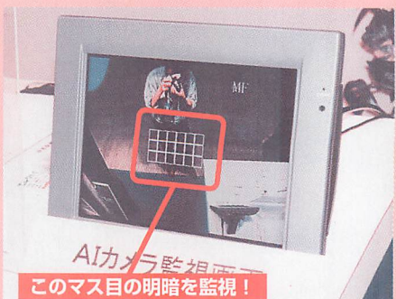
▲AIカメラのモニター映像。画面中央のマス目がセンサーとなるフレーム。各マス目の明暗の変化を捉え、変化を感知するとアラーム信号を出力する。各コマ単位の変化を捉えるだけでなく、明暗の変化がどちらの方向に動いていったかまで判断する能力があるので、一方通行を逆走する車を感知しアラームを鳴らすという芸当もこなす。
