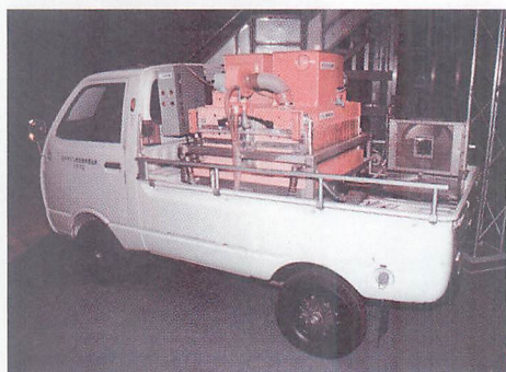
▲これが日本初の燃料電池自動車。1972年(昭和47年)に通産省工業技術院大阪工業技術研究所が松下電器(株)、ダイハツ工業と協力して試作し、走行テストを実施した車。スタート時は燃料電池と蓄電池の両方を使い、通常走行時は燃料電池出力のみで走行します。
