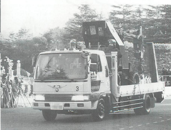
▲爆発物処理用具運送車と処理車 長いマニピュレーターで爆発物を撤去する。
