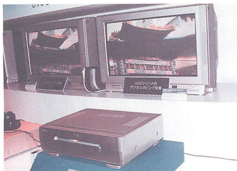
▲MPEG2エンコーダー/デコーダーを搭載するビクターのD-VHSデッキ、HM-DR1000。
