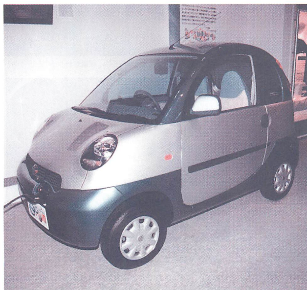
◀試作電気自動車「ECOM」と給電スタンド。トヨタとGM（米・ゼネラルモーターズ）共同開発による小型カブラーを採用した最新の充電器です。従来製品に比べてサイズと重さを半分にし、安全性・信頼性・利便性に優れたインダクティブ方法を採用しています。
