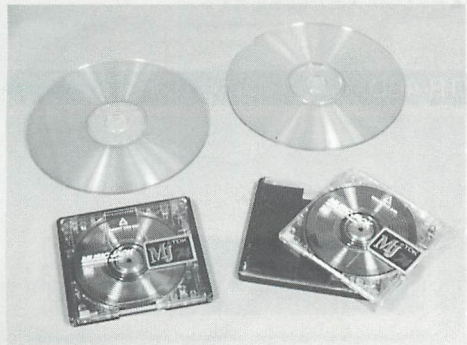
▲CDからMDへのコピーは1回だけ録音可能。さらにもう1世代コピーしようとしてもSCMSによる制限でコピーできない。MDの宿命だ。
