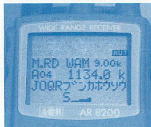
▲AR8200の特徴のひとつが大きなディスプレイ。周波数、モード、ステッ、そして受信中の放送局名を表示する（局名表示はあらかじめ記憶されているもののみ）。
