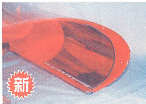
▲新型は散光燈点灯時に後続車両が眩しくないように特別な処理が施されている。
