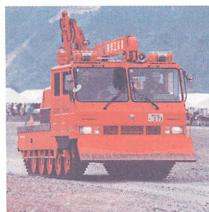
▲当日は普段見ることのできない特殊車両を数多く見られた。 写真は震災工作車で、災害発生時に道路上の障害物を排除して緊急車両の進路を確保し、車両の現場到着を助ける。 車両にはクレーン装置・ドーザー・クローラー・電動ウインチ・油圧シヨベル・カッター付き掘削機・アイアンフォーク等の作業装置を装備している。
