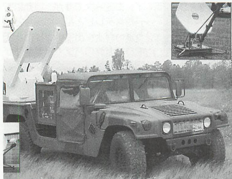
▲写真-4 最近迷彩色を施した軍用SNGも登場した（米国VERTEX社製）。
