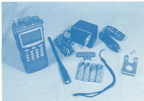
▲AR8200のセット内容。ACアダプター、シガープラグアダプター、充電機が付属する。いつでもどこでも使えるのだ。
