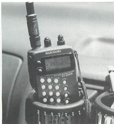
▲イワダテ氏推薦の398.605MHzで盗聴波をキャッチ。強い電波だと上のように車の中で付属のホイップアンテナでもキャッチできる。
