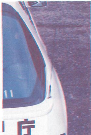
▲警察無線用アンテナは、屋根に設置せずに、リアフェンダーに取り付けてある。そのためアスピライナーに穴を開けて、アンテナ基台を設置するなど苦労の跡が見える。
