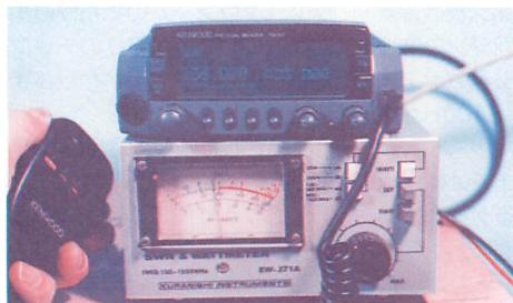
▲TM-V7Aは50/35W機。バンドエッジの136MHzで送信出力を測定中。約40Wで送信できた。しかし、アマチュアバンドを外れたところでハイパワーで長時間送信は、終部が破損する原因になるので避けたほうが無難。
