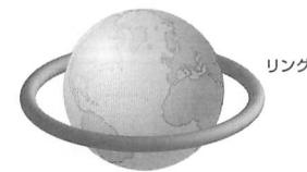
▲チューブ状のリング自身を回転させて、その遠心力と重力を相殺せると地上高を低くできる。その場合、チューブ内部にリングと同じスピードで逆方向に回転する衛星を配置し、そこを軌道エレベーター基地にする
