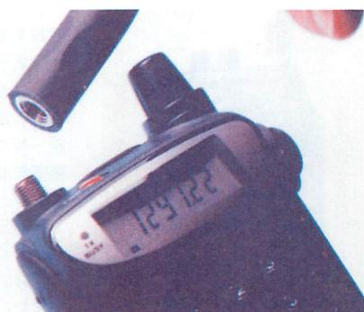
▲C710のアンテナ端子はSMA。取り外しが面倒なのと、アンテナを外したときの形状が美しくない。付属品でキャップを用意して欲しい。
