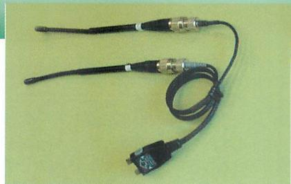
▲携帯電話用のハンディホイップアンテナ。長いのが受信用アンテナ、短いのが送信・受信アンテナ。吸盤付アンテナと異なり、アンテナ自体にコネクターが付いている（コードは別売）。
