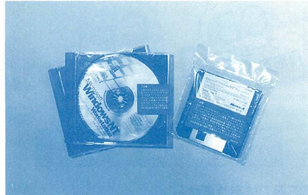
▲CD-ROMが2枚に、セットアップディスクが3枚のNTシステム。DOS/Vはもとより、PC-98、AlphaやPowerPCなどのRISCチップマシンでもインストールできる。
