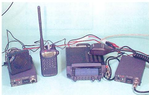
▲送信側をケンウッドTM-V7十ダミーロード、受信側をマランツC510でテストした。
