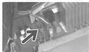
▲電源が入らないときは、ヒューズをチェック。大体125V1~2Aクラスのものが使われているが、交換するときは基板のシルク印刷を確認すること。
