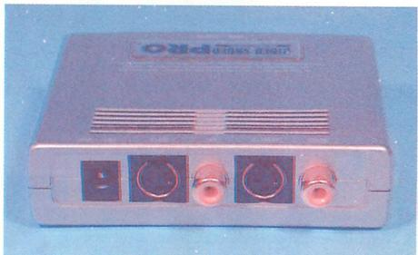
▲VSP777の背面。左から、ACアダプター、S端子入力、ピンプラグ入力、S端子出力、ピンプラグ出力。
