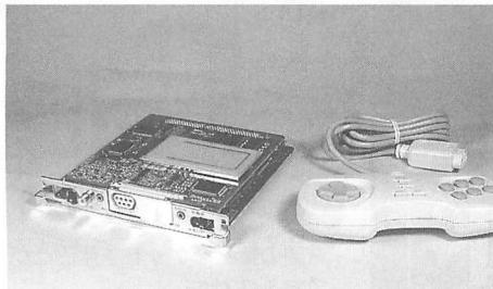
◀ FXゲームアクセラレータボード。写真はボードとコントローラ。このほか、接続用のケーブル3本とACアダプタ、サンブルのCD-ROM枚がセットになっている。ちなみにゲーム開発用「Gmakerスターターキット」は別売りで19,800円だった。
