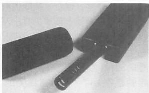
▲風よけを外すと、現れるマイク部。並んだスリットの中間部にある、スリットの途切れたところにコンデンサーマイクが装着されている。
