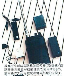
写真中央部は盗聴電波探索器(受信機)、盗聴器発見業者が初動搜索で利用するもの。
