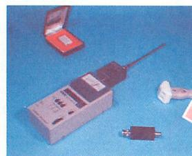
▲実際の盗聴器でテストしてみた。広帯域プリアンプの併用で、測定範囲がどのくらい拡大するかを確認した方が、よりスムーズに探索できる。
