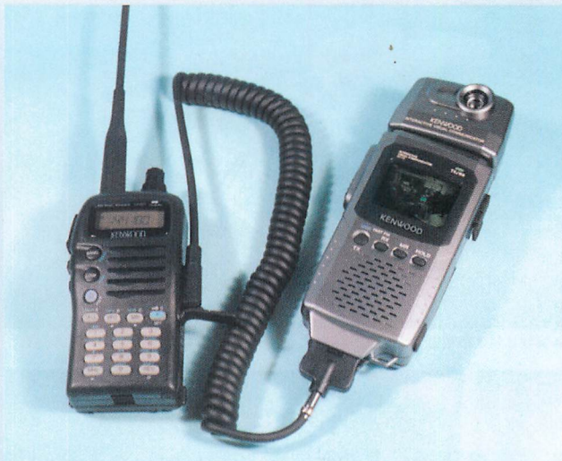
▲TH-G71にVC-H1を接続。これだけで静止画送受信システムの完成だ。
