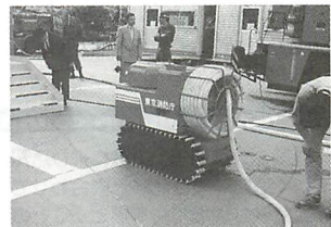
▲高温でもホースが使用できるように濡れホースを使っている。
