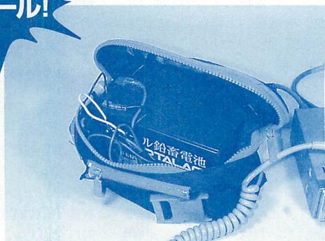
▲電源は12V6.5Ahの鉛シールドバッテリーを使用。
