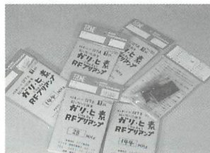
▲FCZのプリアンプキットを改造してミキサーとして使うと便利。
