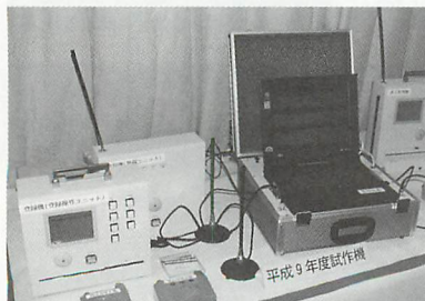
▲隊員安全管理システムの試作機。隊員に異常があると、名前をパソコンのディスプレイに表示したり、危険な場所に入ってしまったとき、その経過時間を表示させたりできる。
