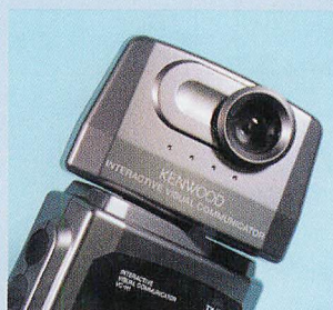
▲180度反転させることができるCCD カメラ。もちろんカラーで撮れる。
