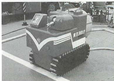
▲リモコン操作で建物内の消防活動にあたる消火ロボット。階段も上り下りできるスゴいやつなのだ。
