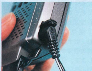
▲VC-H1本体には外部電源端子があるので、付属のACアダプターが利用できる。
