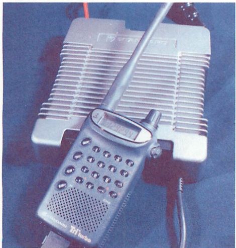
▲C710とCPB710の組合せは最強のコンビだ。144/430/1200MHzのアマチュア帯にハイパワーでオンエアできる。
