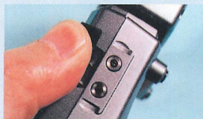
▲本体脇にはコンピューターからコントロールするためのCOM端子(上)と映像出力端子(下)がある。映像端子の出力をテレビに入力すれば大画面で受信した映像を楽しむことができる。
