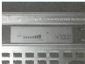
▲試しにSG出力の4.7MHzを記録再生してみた。バンド内はかなりノイズレベルが高いので、ATT内蔵の受信機か外部ATTを用意した方がよいかもしれない。
