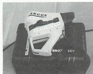
▲熱源を確認できる赤外線カメラ。モニターと一体になっている。煙の中の火の確認ができる。
