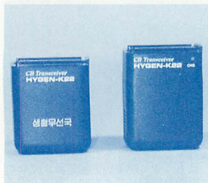
▲左が乾電池ボックスで右側がオプションのニッカドバッテリーパック。容量は700mA!
