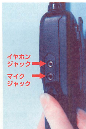
▲TH-G71のスピーカー・マイク端子は他社とは逆になっている。マイク端子が3.5ミリ径（下）、スピーカー端子が2.5ミリ径（上）のミニジャックを使っている。
