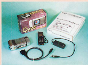
▲別途用意するのは、デジタルカメラとモバイルアダプタ、接続ケーブルと携帯電話。
