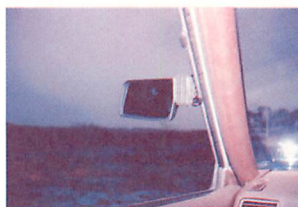
▲ナビミラーを取り付けることにより、助手席でも後方の確認ができる。
