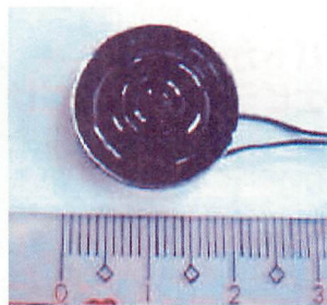
▲今回用いた超薄型スピーカー。大きさも直径2 cmと、小さい。
