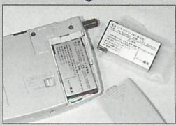
▲バッテリー本体に端子があることで、リード線による配線がないため交換はスマートに行える。
