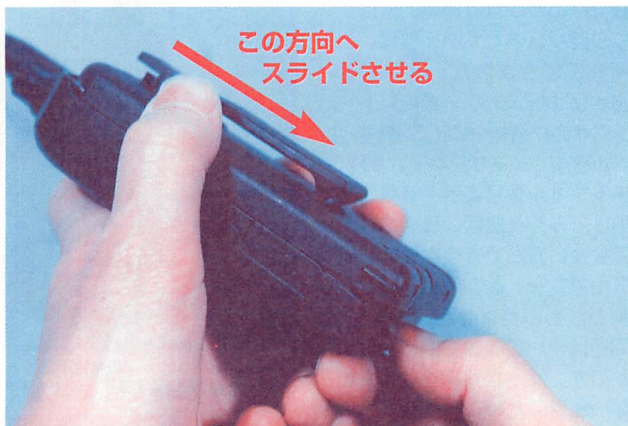
▲TH-G71の電池のバックの外し方を正しくマスターしよう！ ①まず、ツメをリリース方向に押しながら、電池パックを写真の矢印方向にスライドさせる。
