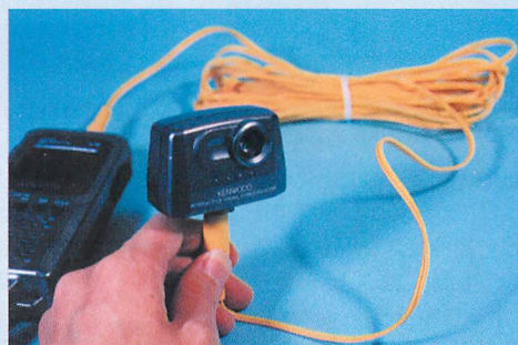
▲CCDカメラは脱着が可能。延長コードで、カメラ部だけを独立させることができる。
