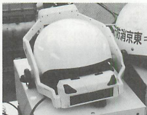
▲操縦者がかぶるヘルメットには左右の目にモニターが付いているゴーグルが付いている。これで立体視可能。
