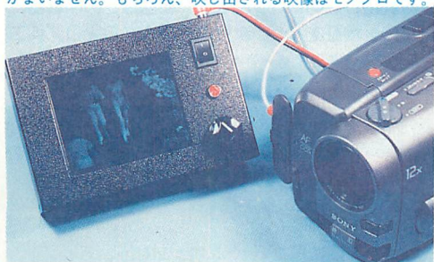
▲簡単に作れるので監視・赤外線カメラのモニターとして活用してみましょう（これは赤外線フィルタ（スケスケケン）の実験画面）。
