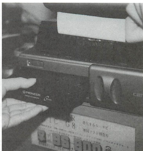
▲パイオニアは独自システムだが、それゆえに設計が巧み。地図ソフト「ロードナビゲーター」は全国を7枚でカバーするが、本体にCDチェンジャーが組み込まれていれば、各ディスクの境界付近で自動的にCD-ROMがチェンジする。
