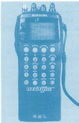
▲目的周波数が変な電波で受信できないことが多い受信機は感度の上げ過ぎが原因。機種によっては起きないものもあります。
