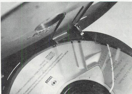
▲なんとフタの内側にあるフラットケーブルがディスクで削られ断線しているのが判明。これは設計ミスだ!
