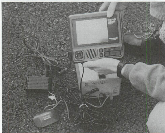
▲松下の一体型カーナビ KX-GA3 をバッテリー駆動する。本機はモニタと CD-ROM プレーヤーが一体になったポータブル操作も可能なカーナビだ（本来はポータブル用オプションのバッテリーを用いるのだが、とても高価なので、編集部にあったバッテリーを活用）。
