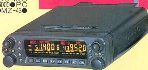
改造することでワイドFM受信もできる50/144/430MHz帯トリプルバンドモーター機「マランツIC5900」
