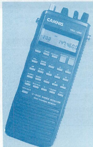
▲目的周波数が変な電波で受信できないことが多い受信機は感度の上げ過ぎが原因。機種によっては起きないものもあります。
