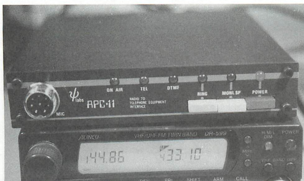
▲無線機と電話機を接続するためのインターフェース、APC-11。2線式(電話)の伝送方式を4線式(無線機)の伝送方式に変換する装置だ。
