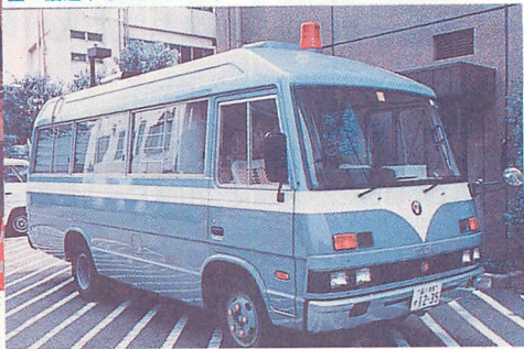
▲こちらは従来タイプの護送車。金網がないが内部にパイプが張ってある。前輪のすぐ後ろの金具は自動ドアタイプのガードだから不用意に開けないようになっている？
