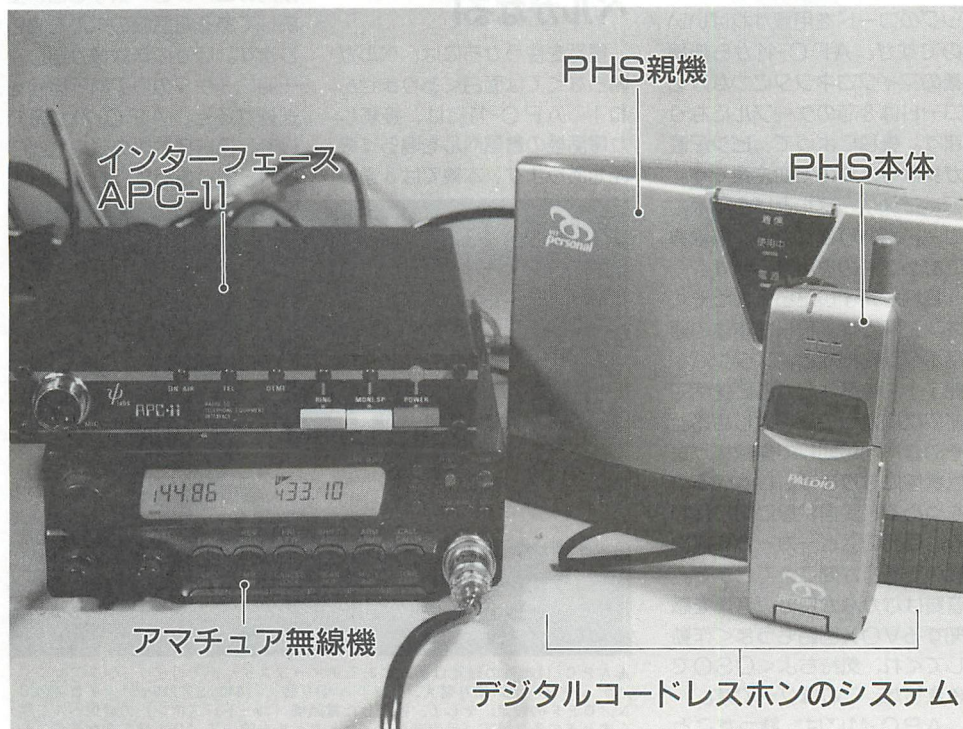
▲アマチュア無線機をコードレス化するためのシステムI式。無線機、PHS本体、PHS親機、APC-11。無線機はデュプレックス運用するのでなければ、シングルバンド機でもOK!
