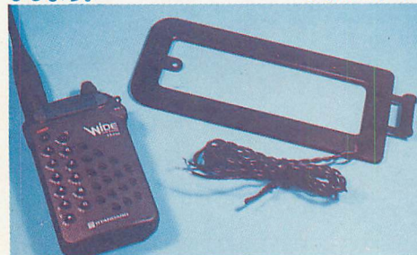
▲秋月電子通商で売られていたAMラジオ用のループアンテナ。コンパクトなので携帯するにはよいのですが、DXには向きません。
