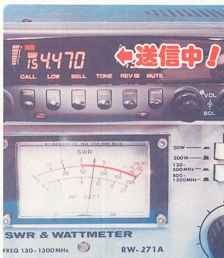
▲422MHz帯の特定小電力帯でも約7Wで送信可能。
