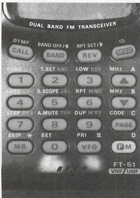
▲DTMF機能付ハンディ機には0～9・A～D・*・#の16個のキーが付いています。DTMF機能を使うと、特定の相手局のみを呼び出して交信することが可能になります。
