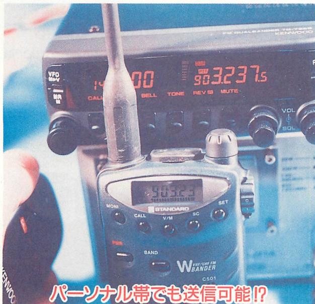
▲パーソナル無線でも電波が出るが、数十mWの微弱パワー。近距離との通信なら使える。900MHz帯の送信は400MHz帯の高調波を利用している。
