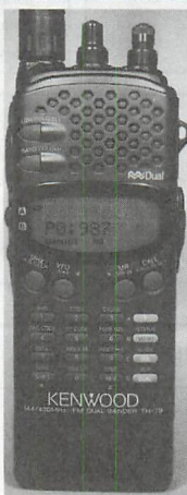
▲▶DTMF機能が付いていると特定の局と交信することができるコードスケルチ（写真のTH-79の場合DTSSと呼ぶ）やページャが使えます。
