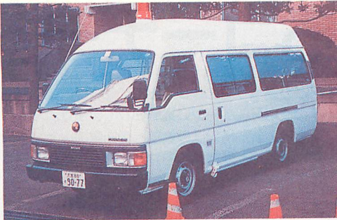
▲こちらは従来タイプの護送車。金網がないが内部にパイプが張ってある。前輪のすぐ後ろの金具は自動ドアタイプのガードだから不用意に開けないようになっている？
