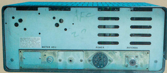
▲MODEL "T"の裏面。D C 100 Vで動作、アンテナ用にM型コネクタを備える。
