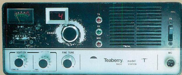
▲Teaberryというメーカー名の固定タイプのC B機、MODEL "T"。C Bの大メーカー(?)、NASAの機種、46VBのコピー機だ。
