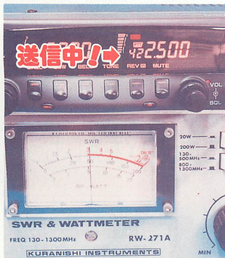
▲オフバンド送信の証。150MHz帯業務バンドでも8W近いパワーで送信できる。
