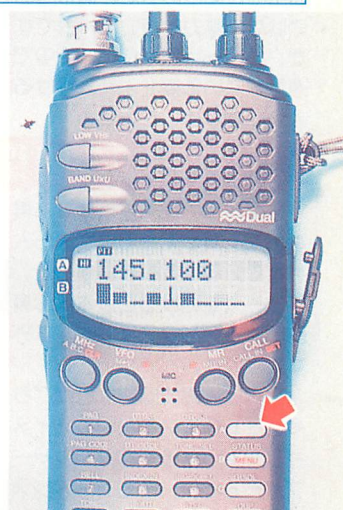
▲▼ビジュアルスキャン機能を使えば、中心周波数を中心に上下4チャンネルを表示する。受信レベルはドットマトリックスによって4段階表示する。中心周波数をモニタしたい場合には、VISUALかPAUSEキーを押して機能を止める必要あり。
