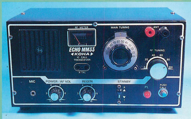
▲使っていたという人というのは聞いたことがないが、みんなが気にしていたのは事実、光波無線のM33だ。中央のメインダイヤルはギアで減速するハードなもの。無線家の魂が揺さ振られるメカだ。
