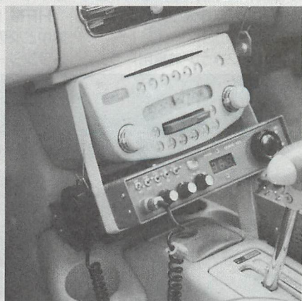
▲車で運用するのも自作無線機！3.5~50MHzでモバイル運用している。コンソールに操作部を配置し、リニアアンプ部は座席の下にセットされていた。自在にセバレート化できるのが自作ならではの。
