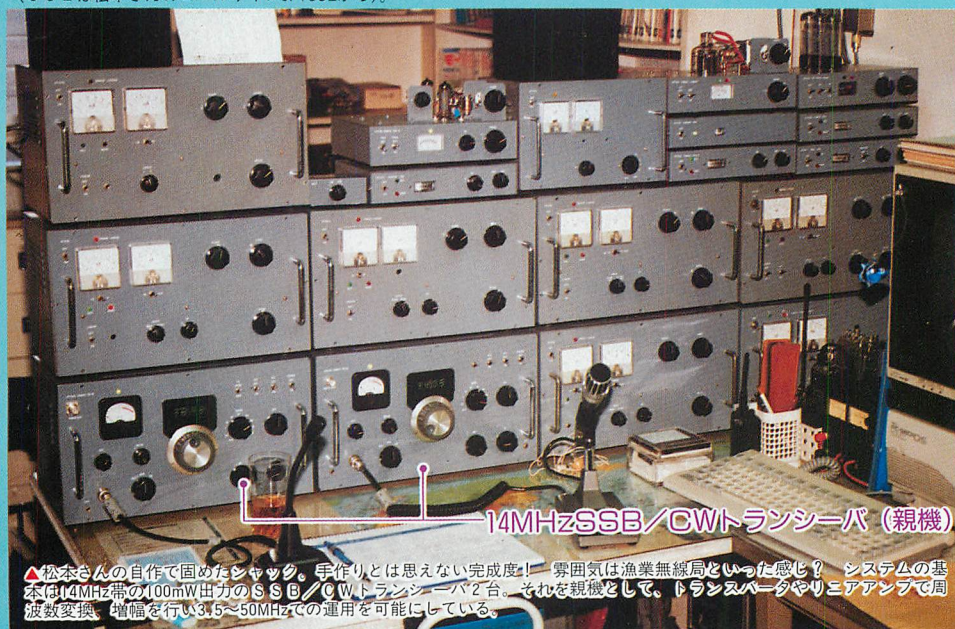
▲ 自作3.5～50MHz帯100W（50MHzは50W）トランシーバ、名付けてT-R-16。松本さんはこの機種を「コリンス」と呼んでいる（笑）。その心は「COL Lines」（COLは松本さんのコールサインJPICOLから）。
