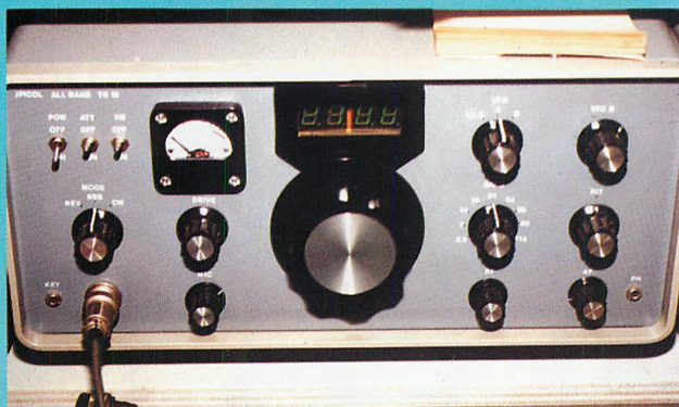
▲ 自作3.5～50MHz帯100W（50MHzは50W）トランシーバ、名付けてT-R-16。松本さんはこの機種を「コリンス」と呼んでいる（笑）。その心は「COL Lines」（COLは松本さんのコールサインJPICOLから）。
