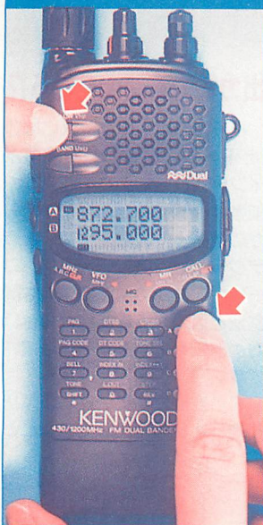
▲Fキーを押した後にVHFキーを押すことにメイン側 (PTT表示のある方) のバンドが切り替わる。300MHz帯と800MHz帯の同時受信も可能だ。
