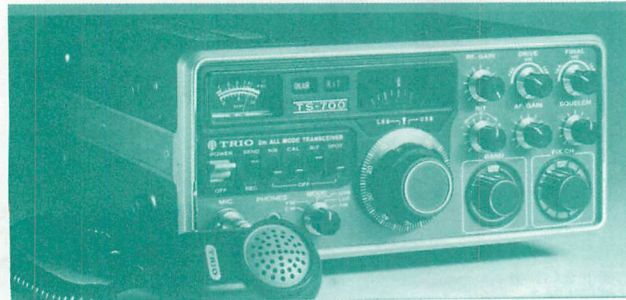
▲144MHzオールモード固定機、TS-700。FM、USB、LSB、CWに加えAM送信もできる真のオールモード機だ。
