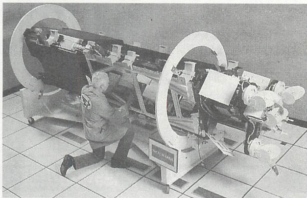
▲写真-1 いよいよ製造段階に入ったイリジウム衛星。組み立ては水平に置かれ、内部のコンポーネントへのアクセスが容易なのが特徴。
