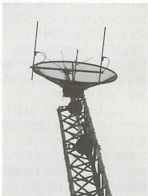
▲パラボラアンテナでリピータを狙う！ 広域リピータは良好にアクセスできた。
