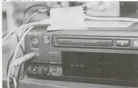
▲編集部のファックス装置（ターゲット）のラインに電話録再アダプタを接続し、通信の一部始終をMDに録音する。
