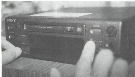
▲MDの編集機能を使い、受信側（ターゲット）の信号をブランク（無音状態）と差し替える。作業は実に簡単。
