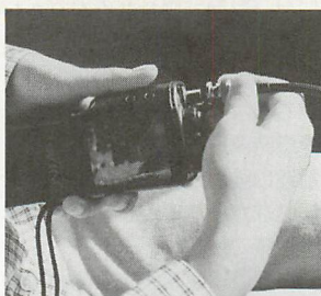
▲C560のアンテナコネクタはBNC端子なので外部アンテナはセットしやすい。
