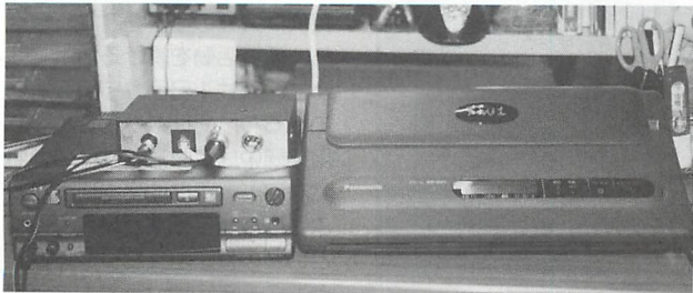
▲ファックスの受話器を持ち上げ、ファックス・スタートボタンを押し、すぐにMDの再生ボタンを押す。あとは受話器を下ろし、プリント・アウトを待つ。
