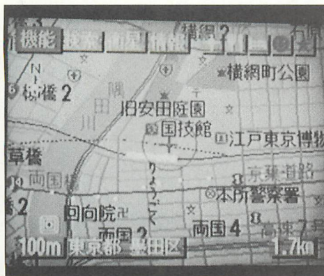
▲「ロードナビゲーターⅢ」の画面表示。白い点が走行軌跡だ。マップマッチング機能がないため測定誤差が現われる。右の写真と比較して欲しい。
