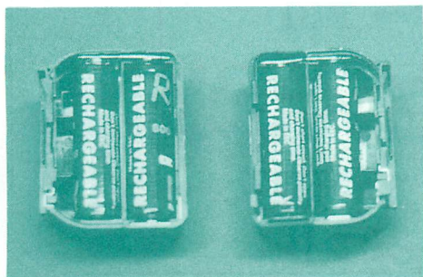
▲単3電池4本パックの内部。電池4本でもLOW、ELパワーでは十分使えた。
