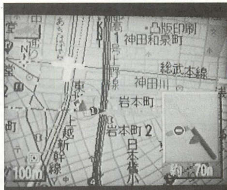
▲ルート設定後、曲がるべき交差点に近付くと、音声でアナウンスすると同時に拡大表示される。車の速度に応じてタイミングが変わるあたりも完成度が高いと思う。派手な機能よりも細かい芸がパイオニアのカーナビの特徴だ。
