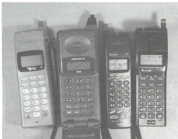
▲携帯電話の種類は実に多い。写真は右からNTTドコモ800MHzアナログ、NTTドコモ800MHzデジタル、IDOの800MHzアナログのタックス方式、東京デジタルホンの1.5GHzデジタル。
