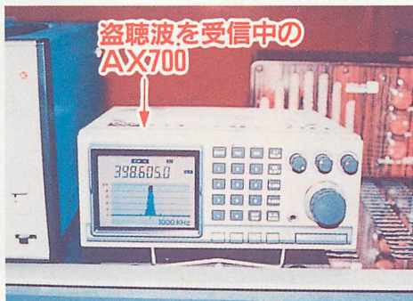
▲調査開始! マランツの受信機、AX700のスペクトラムアナライザが盗聴波の存在を示している(ディスプレイ中央の棒状の表示)。
