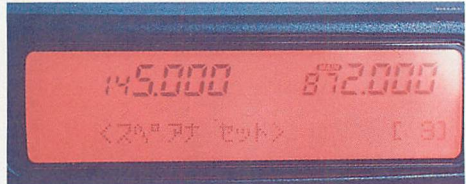
▲スペアナ機能における、1チャンネルあたりのグラフの幅、間隔などの設定はメニューモードで設定できる。各機能でこまかい設定ができるのもFT-8500の特徴だ。
