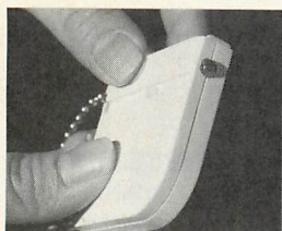
▶▲LED付きキーホルダーは側面にあるスイッチを押すとLEDが点灯する。
