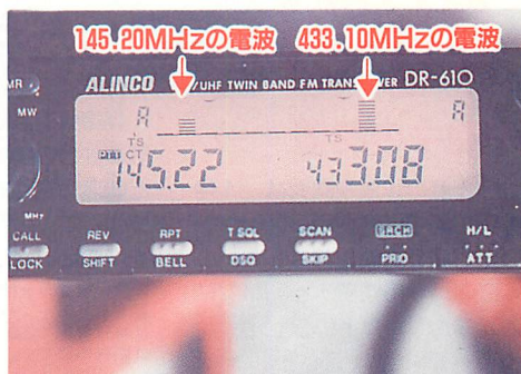
▲簡易スぺアナ（チャンネルスコープ）機能動作中！各バンドで5チャンネルを表示中。145.20MHzと433.10MHzに電波が出ていることが分かる。
