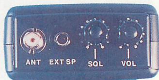
▲本体上面（PR-115/119共通）にはアンテナ端子、外部スピーカ端子、スケルチ、ボリュームツマミが配置。スケルチツマミが装備されているのがうれしい。
