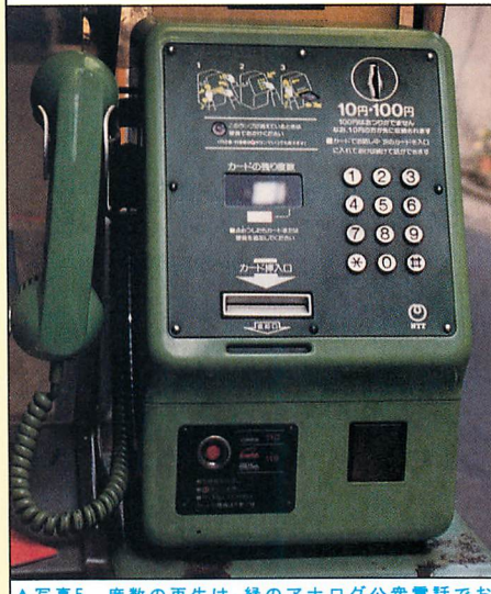
▲写真5 度数の再生は、緑のアナログ公衆電話でおこなう(旧型のMC-1PN・2PNは除く)。デジタル公衆電話で使用した度数が、空通しで元の度数に戻って再生される。
