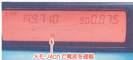
▲スベアナ機能はメモリモードでも使える。1バンクの10チャンネルの様子を一望できる。
