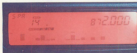
▲スペアナ機能動作中。周波数表示下のグラフが近接周波数をモニタした状況だ。最大140チャンネルを表示する本格的なもの。
