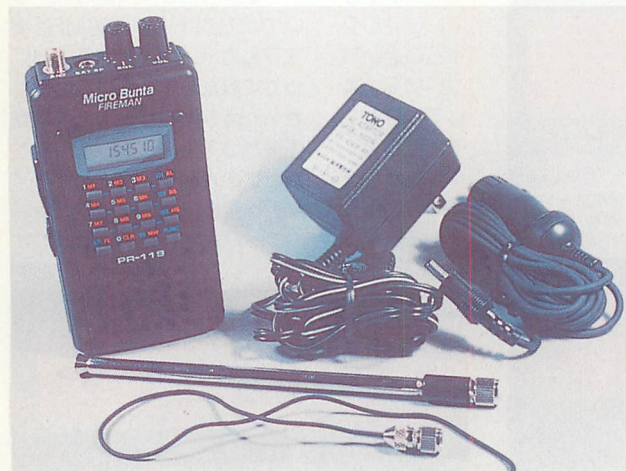
▲PR-119のセット内容（PR-150も内容は同じ）。ロッドアンテナ、ワイヤアンテナ、AC充電器、シガープラグ付DCコードが付属する。
