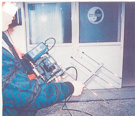
▲指向性の強い八木アンテナを併用し、盗聴器を探す調査員。
