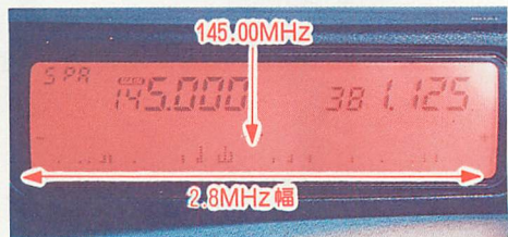
▲最大の分解能の設定で140チャンネルを表示した。写真では中心を145.00MHzとして幅2.8MHzの様子を表示している。144MHz帯のアマチュアバンド(幅2MHz)は楽々全部をモニタできるというわけだ。
