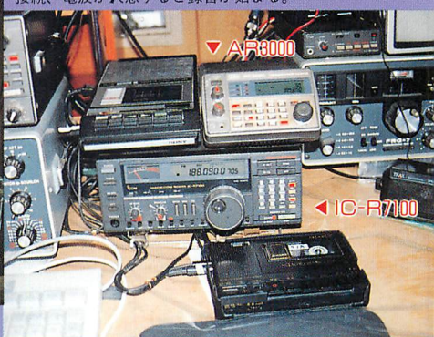
▲豊田さんの受信専用シャック。棚の上のテレビは IC-R7100 と接続されたモニター用だ。
