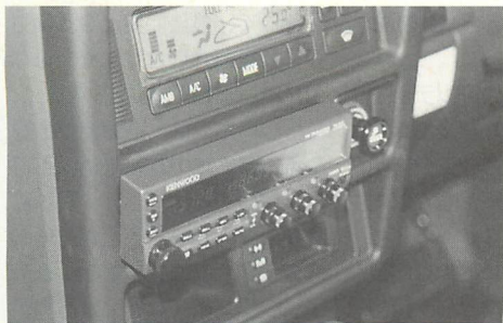
▲車の中にセットしてあるTM-941。144/430/1200MHz帯の3バンドを内蔵するトランシーバだ。
