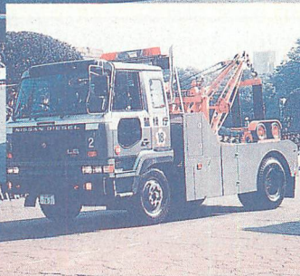
▶大型専用の大型レッカー車で、トラクターがベースになっています。でもショートホイールベースなので、乗り心地は悪いハズ（2機）。
