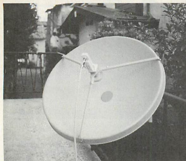
▲55cm径センターフィード型パラボラアンテナ「BG-055GC」。組立ては10分程度で完成する。
