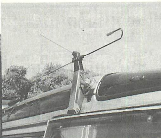
▲テレビアンテナは車両側に付けてダイバシティ方式としている。
