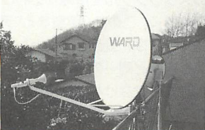
▲写真9 ベランダに取り付けたCSアンテナ(75cmタイプ)。BSに比べると一段と大きい。
