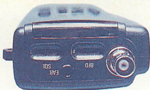
▲ 本体上部はスケルチとBFOの微調整用ボリューム。
