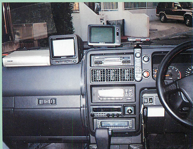
▲ソニーの NVX-F15は、面倒いらずのセッティング。モニター、アンテナ、本体をセッとし電源を確保するだけ。買ってきすぐ使い始めることができる。
