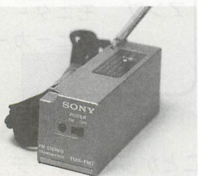
▲市販のFM送信機の一例。微弱電波でも、波長に応じたアンテナを接続すれば飛距離は簡単に延びてしまう。
