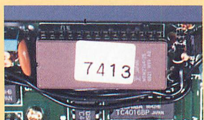
◀このユニットのすべての配線を制御して1やソレノイド、各種センサ類へとつながっている。
