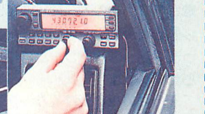
◀⑤セパレートケーブルでボディと前面パネルを正しく接続し、パネルの電源スイッチをオンにすると、このように美しい表示が現われます。マイクケーブルは別系統ですから、好みの場所にセットします。
