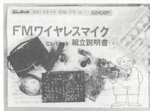
▲CX-1609はケースが付いているので完成度は高い。バッファアンプが搭載されている。
