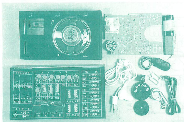
▲ 6石スーパーラジオキットの内容。部品がぐんと多くなる。周波数変換を行なうため、同調回路が複数必要となる。
