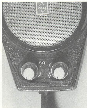
▲スピーカマイクには、音声とスケルトンのボリュームが付いている。
