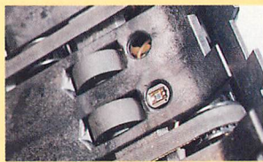
▲これは透かしを見るための赤外線フォトダイオード。位置検出用と違い、アナログ量を見ることが出来るもの。赤外線発光ダイオードと組み合わせて使用されている。磁気ヘッドの近くに設置。
