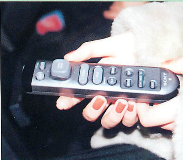
▲操作はワイヤレスリモコンで行なう。キーは個々に特徴があるので、ブラインドタッチで操作が可能。
