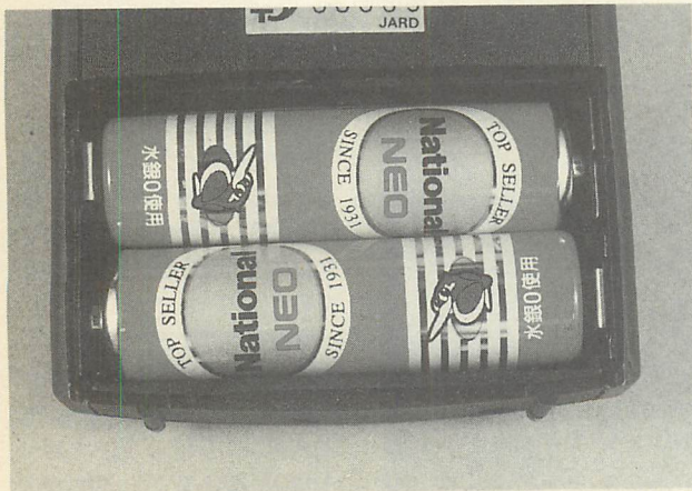
▲使用電池は、単三タイプの電池が、たったの2個。動作電圧は2.0~3.5Vですから、1.2Vのニッカド電池でも使えます。(ただし、取説ではニッカド電池の使用を禁じていますから事故が起っても保証は効きませんよ)。
