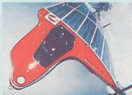
▲太陽電池を屋根一杯に敷き詰めたソーラーカー。空気抵抗が少なくなるように流線形をしている。
