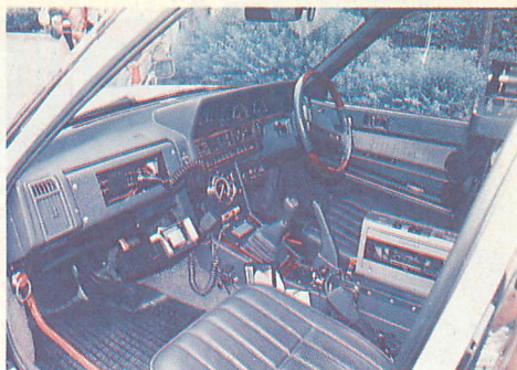
▲日本一(?)の万能探証車「京都210」のコックピット。助手席の膝もとにはカラーモニター、運転席と助手席の間のデッドスペースには、ペンタックス製のVHS式セパレート・ポータブルデッキが見える。
