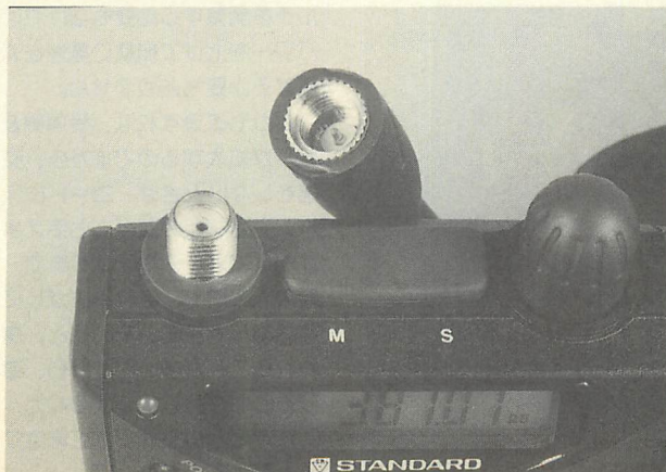
▲アンテナコネクタは小さな SMA タイプが使われている。いくら JAIA 標準のコネクタとはいえ、BNC に比べれば特殊で、専用アンテナっぽいね。
