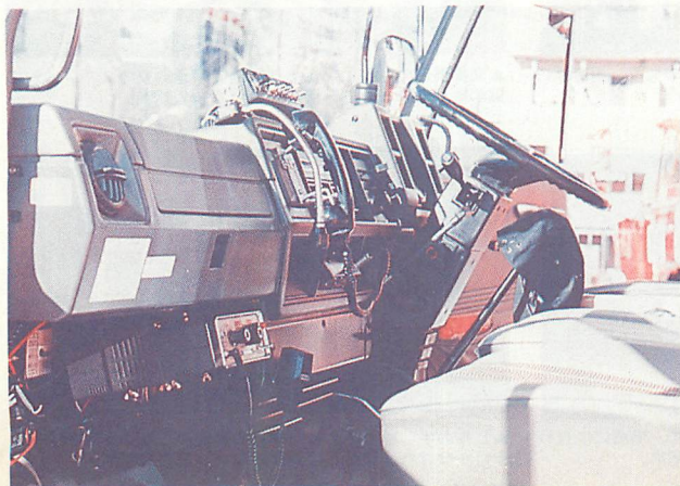
▲年代を感じさせてくれたのはこの無線統制台。4つある受話器はすべて無線通信用で、左から市町村A波、市町村B波、救急波、県内共通波となっていました。
