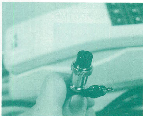
▲トランシーバとは、マイクコネクタとミニジャックで接続する。
