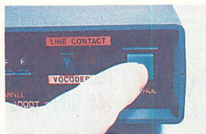
▲本体を作動させるコントロールスイッチ。話相手か自分のどちらか一方がこのボタンを2回押す。もうひとりはい回だけ押すことで動作を開始する。
