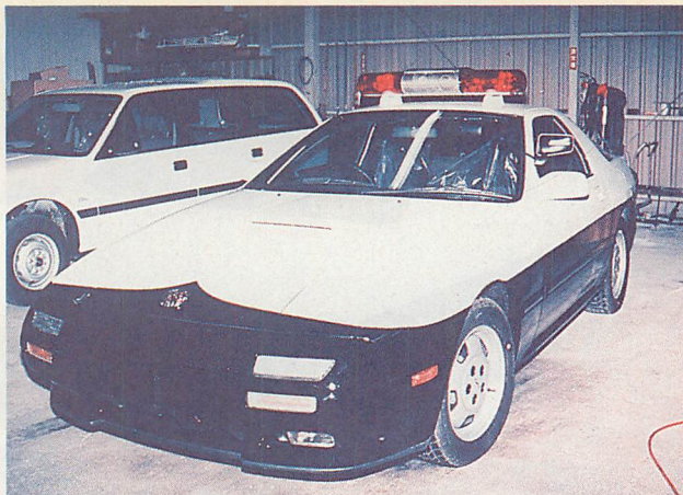
▲広報スピーカ部は小さい回転灯だが、スピーカは前後に向けて2つある。助手席のドアミラーも専用の物を採用している。コストの都合でアルミが履けないのが残念なかりだ。
