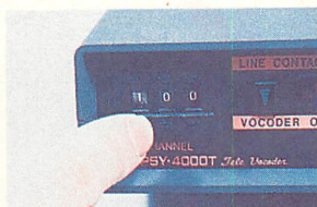
▲▼ サムホイールスイッチは各桁で0～9、A、B、C、Dの16通りが設定できる。よって秘話パターンは16×16×16=4096通りが設定できるのだ。
