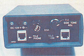
▲ PSY-4000T 背面パネル。電源入力は12VDC。ツマミは音のユレを調整する側音調整用のツマミ。
