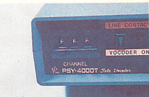
▲▼ サムホイールスイッチは各桁で0～9、A、B、C、Dの16通りが設定できる。よって秘話パターンは16×16×16=4096通りが設定できるのだ。
