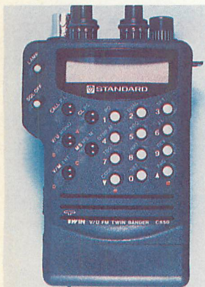
▲外部電源端子は本体にない。バッテリーパック装着部に、外部電源端子用アダプタを装着することになる。
