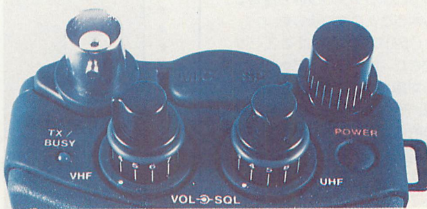
▲ツマミ類はC481に採用されたツマミが、そのまま利用されており、扱いやすいようにできている。同調用の回転ダイヤルツマミは、イヤホンをつなげると指の太い人には少々、回しづらいかもしれない。
