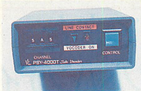
▲ PSY-4000T 正面パネル。秘話パターンを設定するサムホイールスイッチとコントロールスイッチからなるシンプルな構成。
