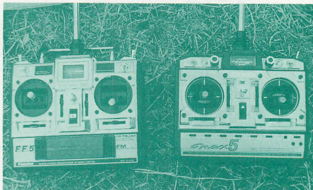
▲代表的な5チャンネルプロポ。左はフタバ「FF5」。右はJR「MAX5」（ヘリ用）。
