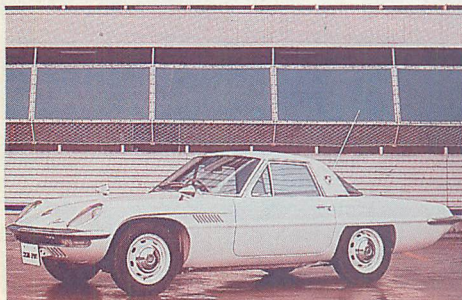
▲左が世界初のロータリー市販車初代コスモ。車重は1トンを切る軽さだ。マツダはロータリー車でレース活動もしている。
