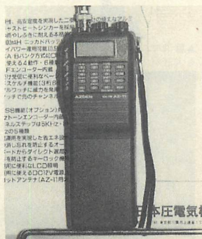
▲日本圧電気、28MHz ハンディ・トランシーバ。AZ-11。
