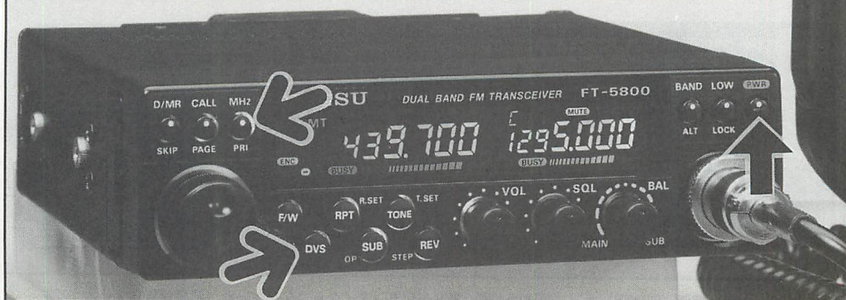
ハード改造後に、[MHz]キーと[DVS]キーを押しながら電源をオンにします。解除は、同じ動作をもう一度。
