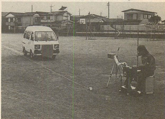
吸収体をサンバーのラジェータ付近にとりつけて測定。(写真③)
