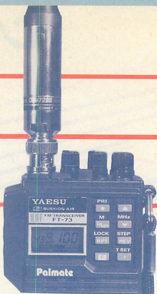
マルドルHS-702Sをつなぎ439.10MHzを受信しているところ。 コメットCH-722Sをつなぎ439.10MHzを受信しているところ。
