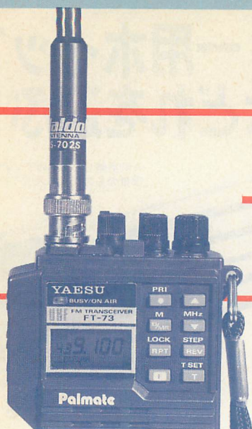
マルドルHS-702Sをつなぎ439.10MHzを受信しているところ。 コメットCH-722Sをつなぎ439.10MHzを受信しているところ。
