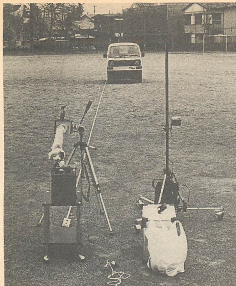
田中チームの測定機器。左から発振器とアンテナ、目標物、受信器。(写真①)
